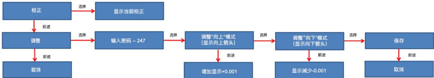
选择**调整**将显示密码的3位数字段。利用前进键，每次输入密码（247）的一位数，将增加一个显示位数。然后，用选择键进入下一位数。按下选择键进入第三位数后，将出现温度显示器，您可以在其中调整显示的温度。箭头指示器显示您更改温度的方向。按下前进键，数值将以0.001度的幅度增加，直至达到10，然后将以每秒0.01度的速率增加。使用选择键，可分别选择向上调整、向下调整、**保存**校正或**取消**（不保存）。保存调整后，您可以在**零点→ 校正→ “显示当前校正”**菜单中查看正在应用的零点调整。
