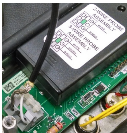
图1：探头组件引线连接
