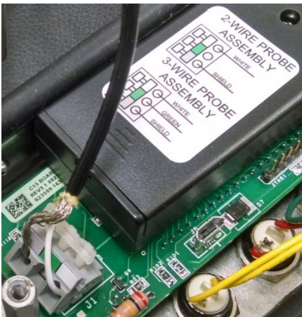
Figure 1 : Connexion des fils de la sonde
