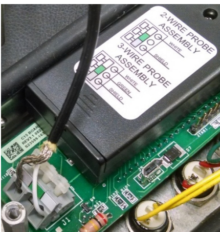
Figura 1: Sujeción del cable del ensamble de sonda
