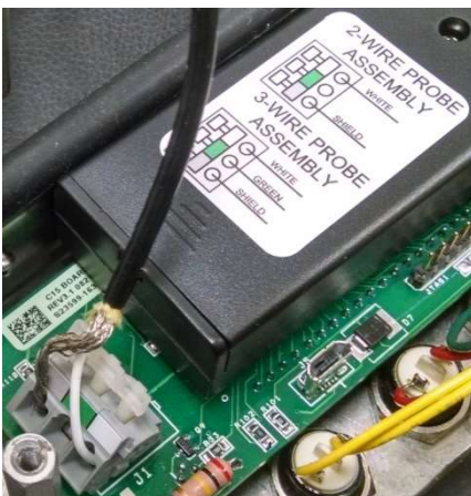
Figure 1: プローブアセンブリリードの取り付け
